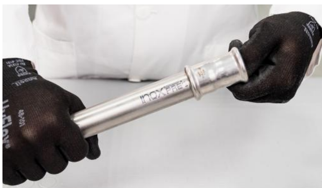
Figura 31 - Inserimento del tubo nel raccordo a pressare
