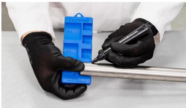
Figura 28 - Marcatura della profondità d'innesto
