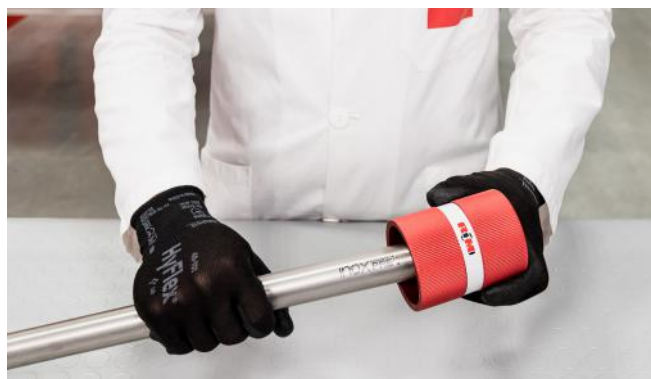
Figura 26 - Sbavatura del tubo
